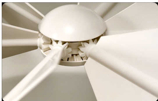
Rysunek 2. Dysk centralny z tworzywa sztucznego ABS.
